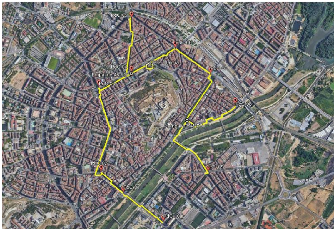
Il·lustració 72. Plànol d'ubicació dels PdC i recorregut de la xarxa de comunicacions Font: ALUVISA.
